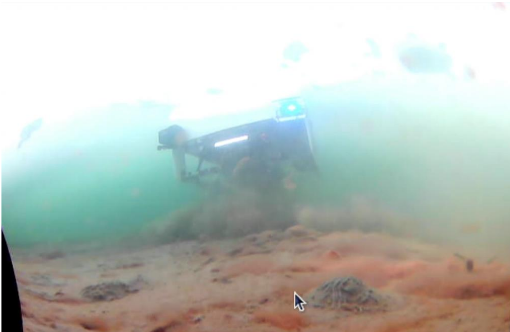
< 「浮上」の OCC 信号を受けて浮上を開始する水中ロボット（子機） >
